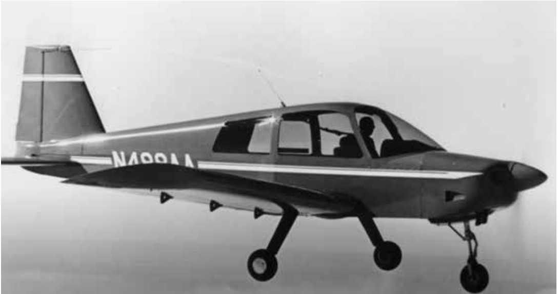
AA-2 Patriot. Die Entwicklung der viersitzigen Variante gelang nicht im ersten Anflug. Die AA-2 Patriot war ein neuer Entwurf mit Türen. Die Flugleistungen waren jedoch enttäuschend. American Aircraft stampfte den Entwurf dann auch ein und besann sich auf die Wurzeln der BD-1/AA-1. Die versitzige Variante wurde auf Basis der AA-1 entwickelt und teilt heute noch eine Menge Bauteile mit dem Vorgängermodell. Bild: AYA
