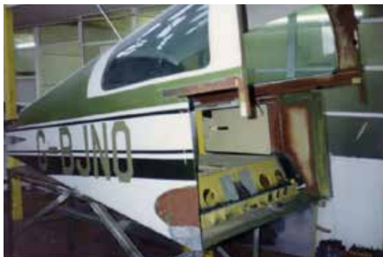
Extrem einfacher Aufbau. Die Modulare Bauweise der AA5 erlaubt es ganze Sektionen auszutauschen und zu reparieren. Das fliegen bezahlbar zu halten war von Anfang an ein zentrales Designziel für diese Baureihe. Bilder: AYA
