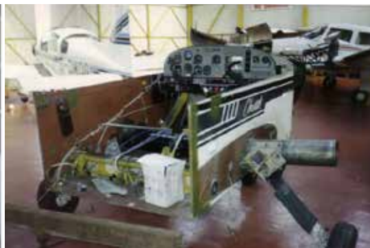
Extrem einfacher Aufbau. Die Modulare Bauweise der AA5 erlaubt es ganze Sektionen auszutauschen und zu reparieren. Das fliegen bezahlbar zu halten war von Anfang an ein zentrales Designziel für diese Baureihe. Bilder: AYA
